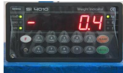
(d) Load indicator in tension state
