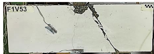
(d) shear compression failure.
