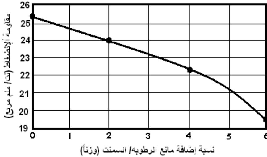
الشكل (٣) انخفاض معدل مقاومة الإنضغاط للخرسانة مع زيادة نسبة إضافة مائع الرطوبة / الاسمنت (وزناً)
