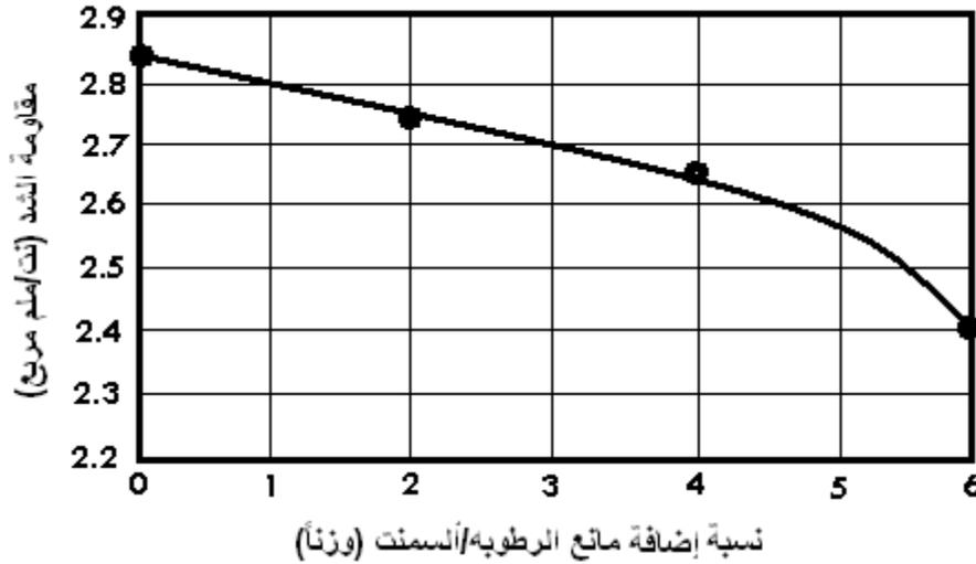
الشكل (٢) إنخفاض معدل مقاومة الشد للخرسانة عند زيادة نسبة إضافة المادة المانعة للرطوبة/الاسمنت (وزناً)
