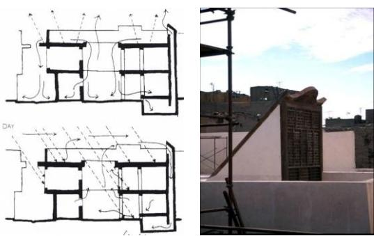
هو عبارة عن مهوى يعلو عن المبنى وله فتحة مقابلة لإتجاه هبوب الرياح السائدة لاقتناص الهواء المار فوق المبنى والذي يكون عادة أبزد ودفعه إلى داخل المبنى ويفيد الملفق أيضاً في القليل من الغبار و الرياح التي تحملهما عادة الرياح التي تهب على الأقاليم الحارة ويعتمد حجم الملفق على درجة حرارة الهواء في الخارج فإذا كانت درجة الحرارة عند مدخل الملفق متدينة وجب أن تكون مساحة مقطعه الأفقي كبيرة أما إذا كانت درجة الحرارة أعلى من الحد الأقصى للراحة المتعلقة بالبيئة
