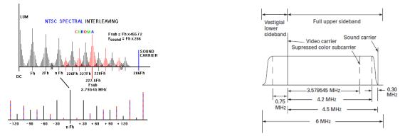
Figure(6) NTSC spectral<sup>[7]</sup>
