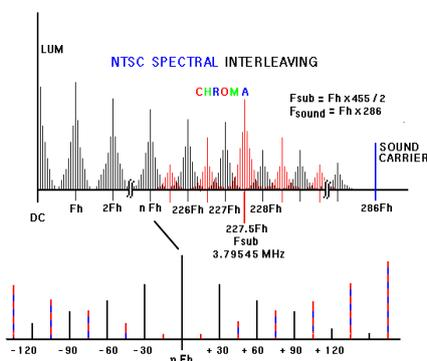
**Figure(6) NTSC spectral<sup>[7]</sup>**
