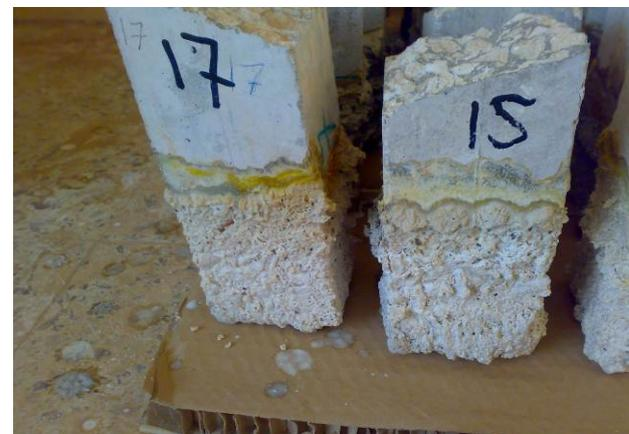
شكل (3):- صور تبين المواشير المعاملة بحامض الكبريتيك المخفف اثناء وبعد المعاملة (صور المعالجة بعمر ٢٠ يوم)
