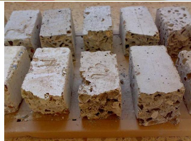
شكل (٢):- صور بعض المواشير قبل وبعد المعاملة بحامض الهيدروكلوريك المخفف (صور المعالجة بعمر ٢٠ يوم)
