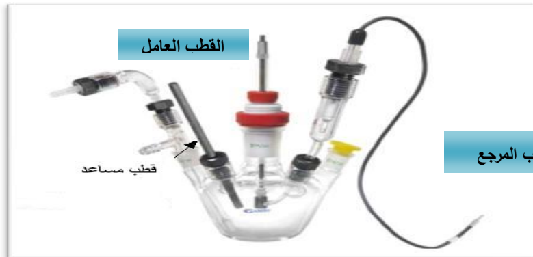
الشكل (٢) الخلية الكهروكيميائية المستخدمة في الدراسة.
